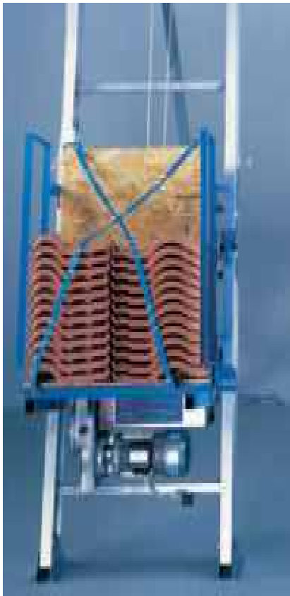
FIGURA 8: A- PIANO PORTATEGOLE; B - PIANO PORTALASTRE
