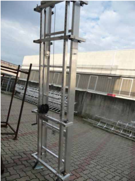
FIGURA 6: ACCESSORIO PER L'INSTALLAZIONE IN CASO DI ESTENSIONI SUPERIORI A 6 METRI
