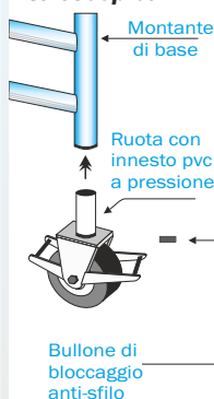
[Fig. 2]: Montaggio ruota senza gamba telescopica
