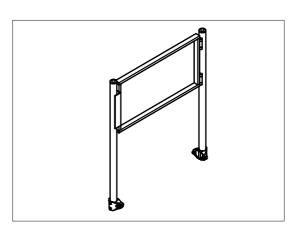
Dopo aver verificato il corretto posizionamento del cancello provvedere a caricare la molla tramite l'apposita astina di carica e il perno di arresto.
