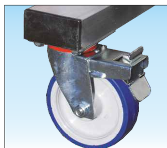
Ruote Ø 125 mm girevoli con freno e nucleo in poliuretano anti-schiacciamento e fascia d'appoggio blu anti-traccia
