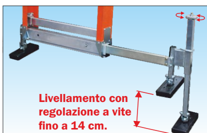
Basetta telescopica con chiusura a scomparsa e piedi basculanti che si adattano al terreno; dotata di n° 1 piede livellatore in acciaio zincato con regolazione a vite che può essere montato e smontato all'occorrenza per colmare pendenze o dislivelli con facilità e precisione
