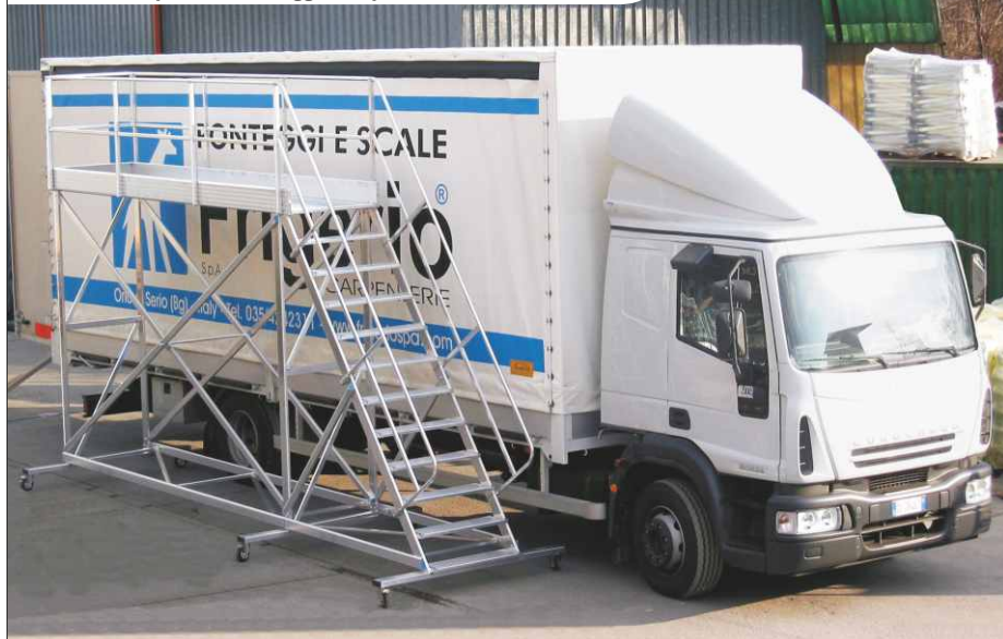
Scala 7780 con piattaforma maggiorata per manutenzione automezzi
